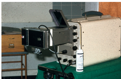
Рис. 1.1 Эхограф фирмы Kranzbühler (Золинген), применявшийся в 1973 г., при помощи которого были сделаны первые попытки УЗИ околоносовых пазух датчиком с рабочей частотой 3,5 МГц в А-режиме (фотография приводится с разрешения инженера Карп).
