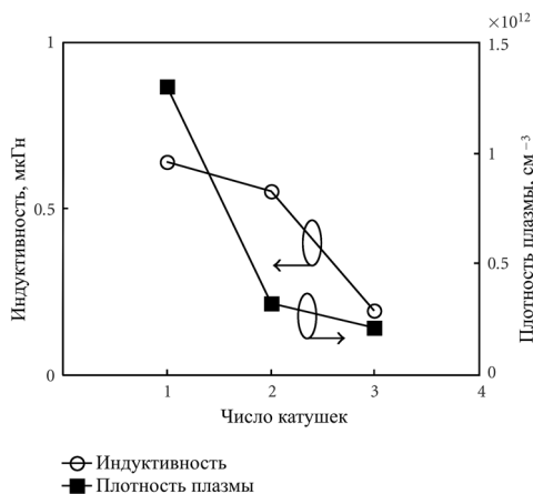
Рис. 2.26. Индуктивность нескольких катушек, соединенных параллельно, и плотность плазмы в зависимости от числа катушек [30]. Условия эксперимента: поток аргона 30 \text{ см}^3/\text{мин} , его давление 1,3 Па, ВЧ мощность разряда 1000 Вт
