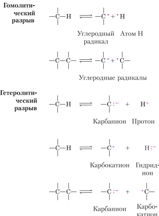
**Рис. 13-1.** Два механизма разрыва связей С—С и С—Н. При гомолитическом разрыве связи каждый атом сохраняет за собой один электрон, что приводит к образованию углеродного радикала (углерод имеет неспаренный электрон) или незаряженного атомарного водорода. При гетеролитическом разрыве связи оба электрона остаются связанными с одним из атомов. При этом образуются карбанионы, карбокатионы, протоны или гидрид-ионы.
