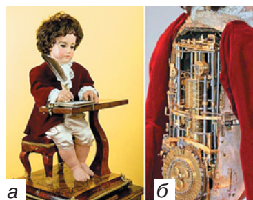
Рис. 1.5. Пишущая кукла: а — внешний вид; б — внутренний механизм
