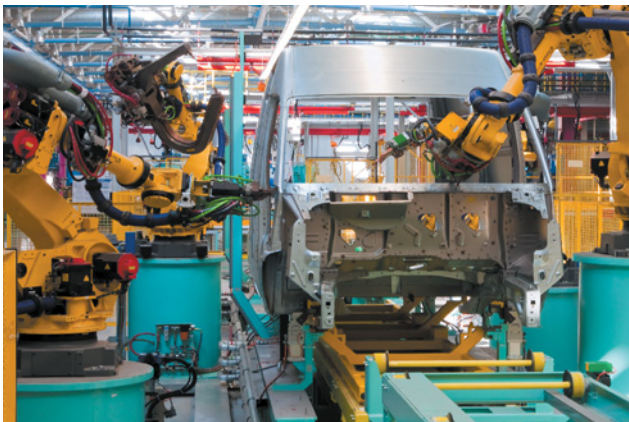
Рис. 1.8. Конвейер по сборке автомобилей промышленными манипуляторами
