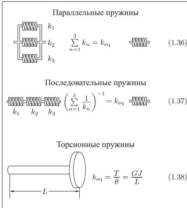
Рис. 1.7. Эквивалентные пружины
