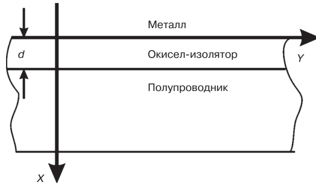
Рис. 1.1. Эскиз типовой МОП-структуры
